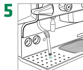
5 Sfogare la pressione della caldaia con la lancia vapore e controllare che la pressione della caldaia venga raggiunta di nuovo
