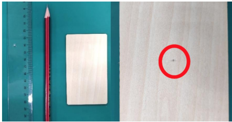
Image 1 dessiner un point central sur l'objet gravé
