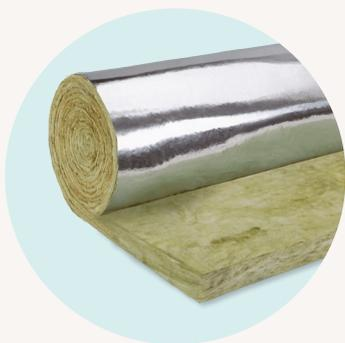
Manta de lana mineral URSA AIR para el aislamiento exterior de conductos metálicos de climatización conforme a la norma UNE EN 14303, recubierta por su cara exterior con complejo kraft-aluminio que actúa como barrera de vapor.
