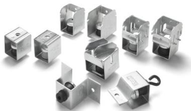
Gama diseñada para la suspensión de falsos techos acústicos y maquinaria trabajando a partir de 1.000 r.p.m. En toda la gama Akustik se mantiene el mismo elemento antivibratorio fabricado en caucho de gran calidad mecánica, especialmente diseñado para el aislamiento vibratorio. La estructura metálica es resistente a más de 650 kg y recubierta de baño electrolítico bicromatado.
