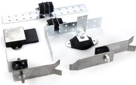
Los soportes EP están fabricados en múltiples formatos para poder adaptarse a las distintas técnicas de colocación de los instaladores. Son especialmente interesantes para las aplicaciones en paredes superiores a 3.5m de altura. Para calcular la cantidad de EP a utilizar, calculamos que debemos utilizar 1 soporte cada 1,5 m de altura. Ejemplo : para un tabique de 4.5m. 2 antivibratorios a 1.5 y 3 m de altura.
