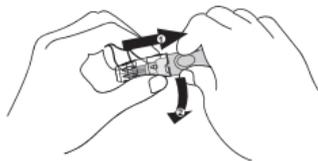
2. Ziehen Sie den Spannregler heraus, bis der orangefarbene Stab im Fenster der Auslösetaste erscheint.
