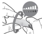
6. Ziehen Sie den Spannregler heraus, bis der orangefarbene Stab im Fenster der Auslösetaste erscheint.
