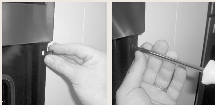
Fissare con le quattro viti in dotazione le boccole al mobile avendo cura di non forzare troppo pena la rottura della boccola stessa.
