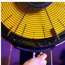
Handmatig instelbaar magnetisch weerstandssysteem
