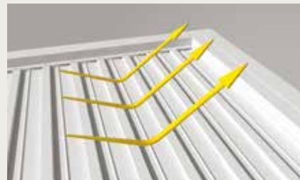
Lame chiuse per schermare la luce del sole Closed blades to screen sunlight
