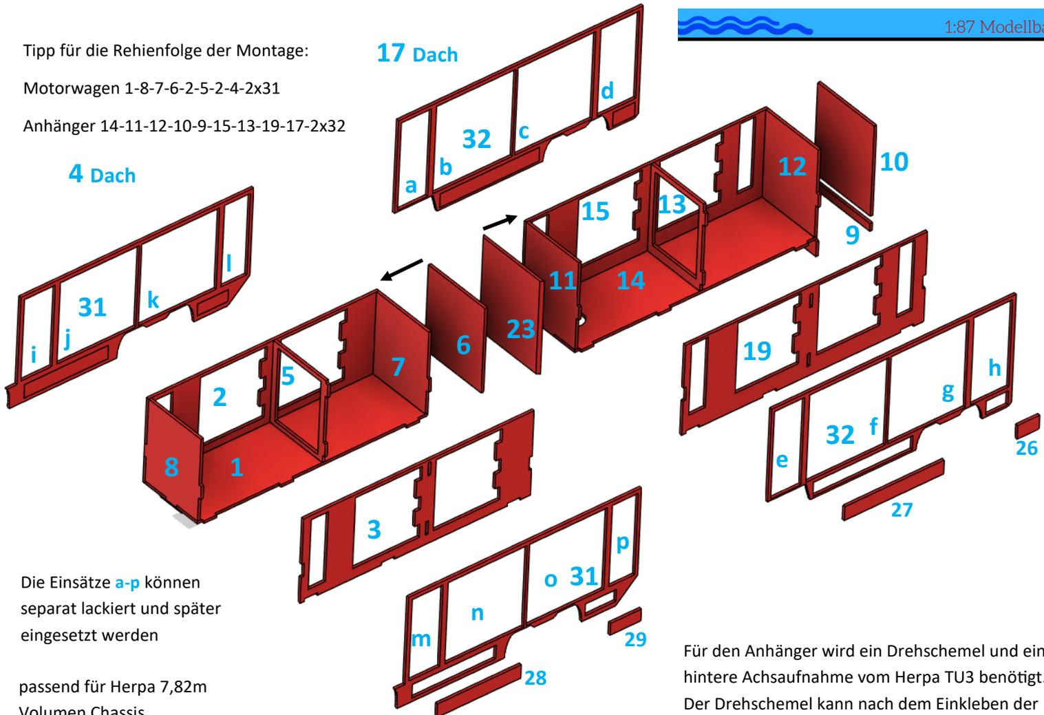
Die Einsätze a-p können separat lackiert und später eingesetzt werden
