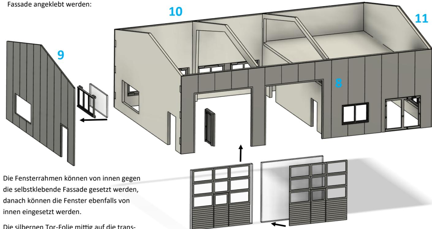
Die Fensterrahmen können von innen gegen die selbstklebende Fassade gesetzt werden, danach können die Fenster ebenfalls von innen eingesetzt werden.
