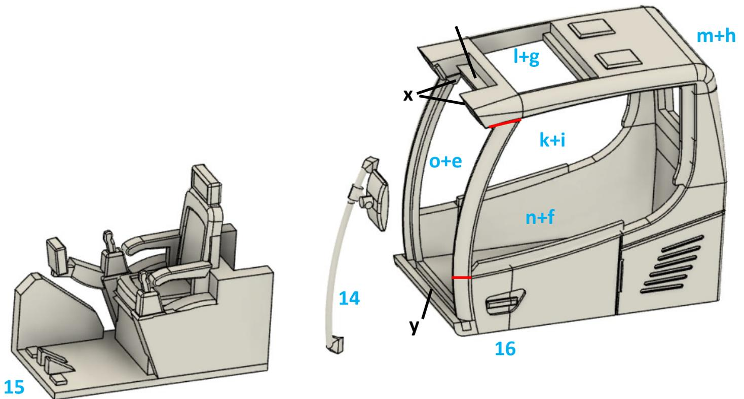
Die Kabinen Karosse muss vor der weiteren Montage lackiert werden. Anschließend können die A –Säulen im rot markierten Bereich mit dünner schwarzer Farbe nachgearbeitet werden .
