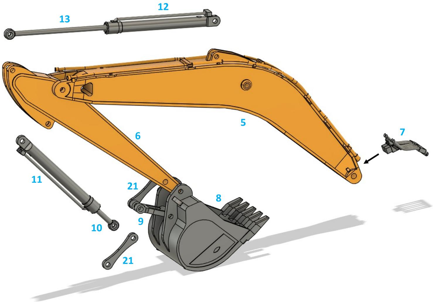
Nach dem Lackieren der einzelnen Bauteile können diese mit dem beiliegenden 0,88mm Profil verbunden werden. Bei Bedarf können die Bohrungen mit einem 0,9mm Bohrer nachgearbeitet werden.
