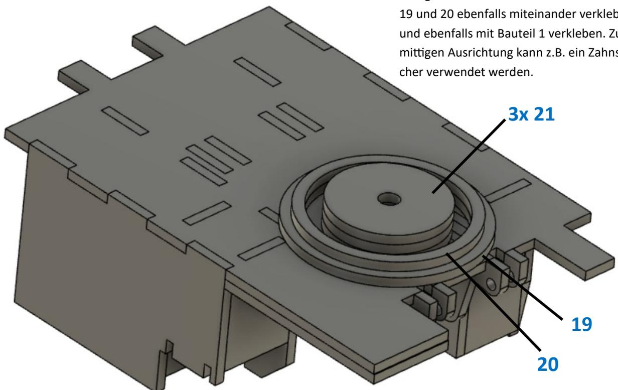
Die Bauteile 21 miteinander verkleben und mittig auf dem Loch von Bauteil 1 verkleben. 19 und 20 ebenfalls miteinander verkleben und ebenfalls mit Bauteil 1 verkleben. Zur mittigen Ausrichtung kann z.B. ein Zahnstocher verwendet werden.
