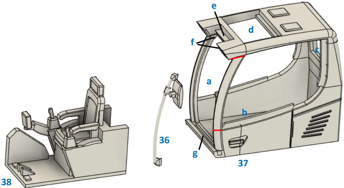
Die Karosse muss vor der weiteren Montage lackiert werden. Anschließend die A –Säulen im rot markierten Bereich mit dünner schwarzer Farbe nacharbeiten.
