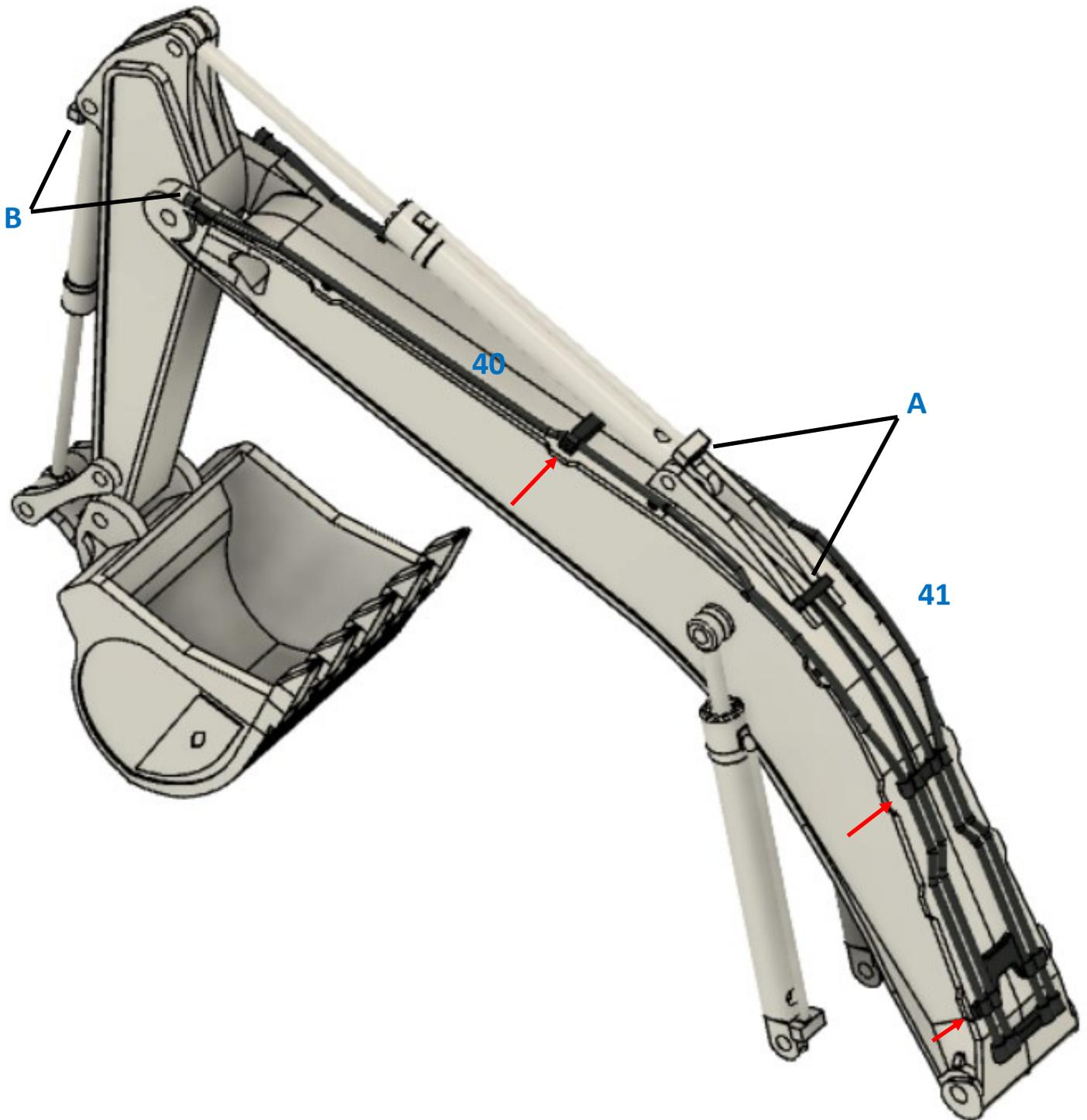
Die Hydraulikleitungen sehr vorsichtig von der Halte-Struktur trennen. Dafür z.B. mit einer Modellbau Säge die Stützen bündig an der Bodenplatte absägen und dann vorsichtig vom Bauteil abbrechen. Nach dem Lackieren können diese am Ausleger montiert werden. Die Roten Pfeile geben eine Hilfestellung bei der Positionierung .
