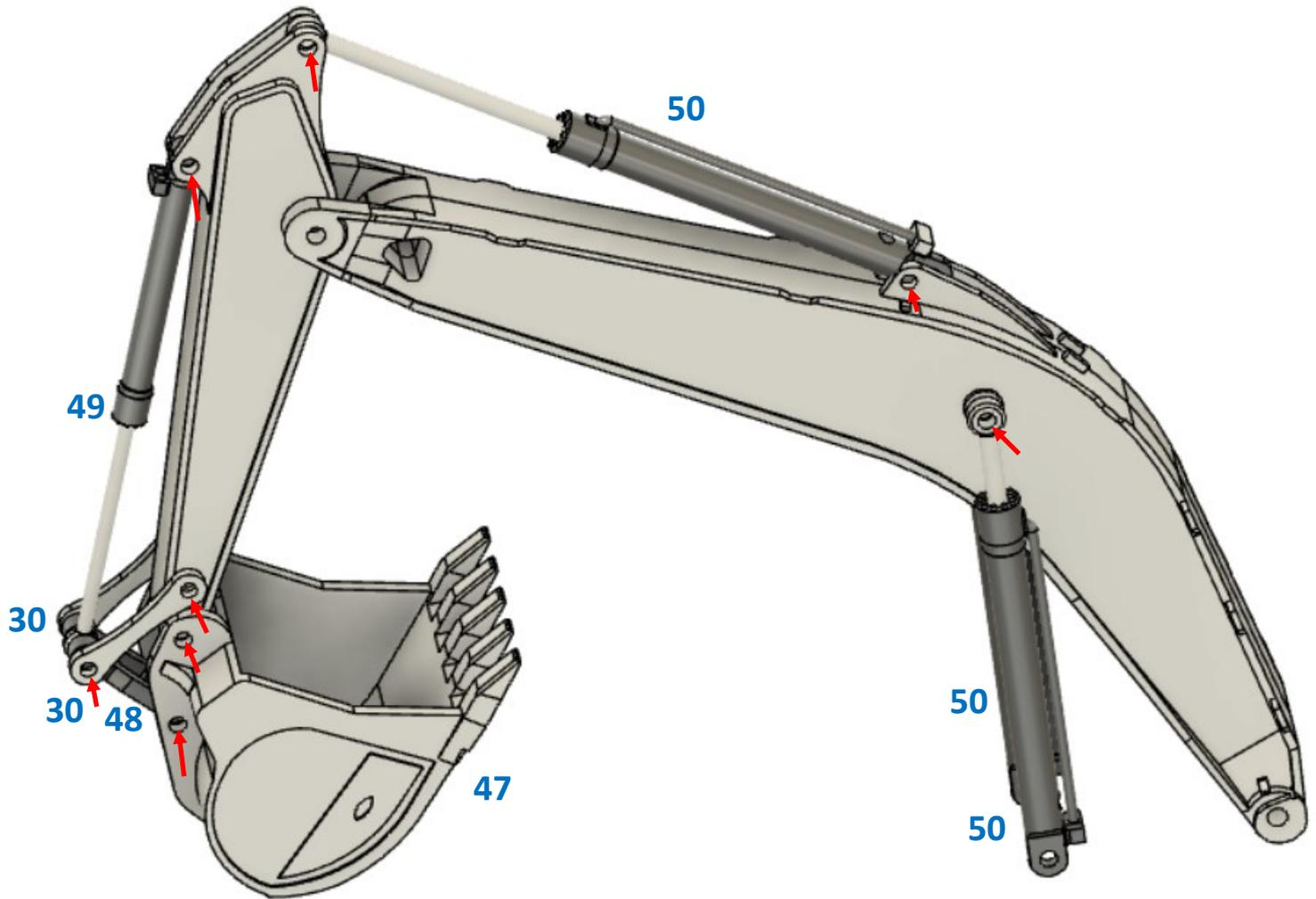
Alle Bauteile sollten vor dem Zusammenbau fertig lackiert und gut durchgetrocknet sein. Die Schaufel kann mit dem Rundprofil an Teil 42 montiert werden. Es folgen die Bauteile 48, 30,30 und der Zylinder 49. Zudem können die 3 weiteren Zylinder 50 montiert werden.
