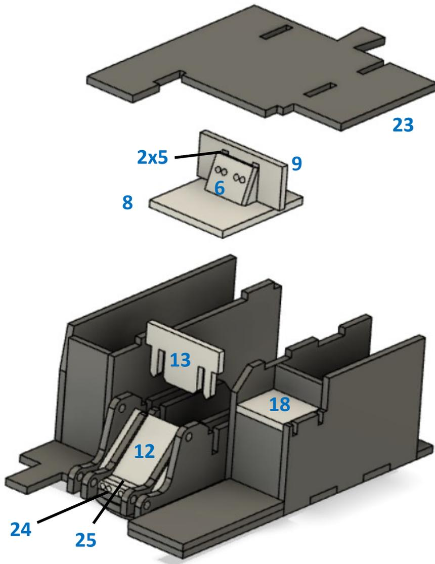
Bauteil 12 schräg von oben zwischen die Träger einsetzen. Bauteil 13 von oben einschieben. Vor Bauteil 12 können 24 und 25 angeklebt werden, als Aufnahme für die Hydraulikschläuche der Hubzylinder.
