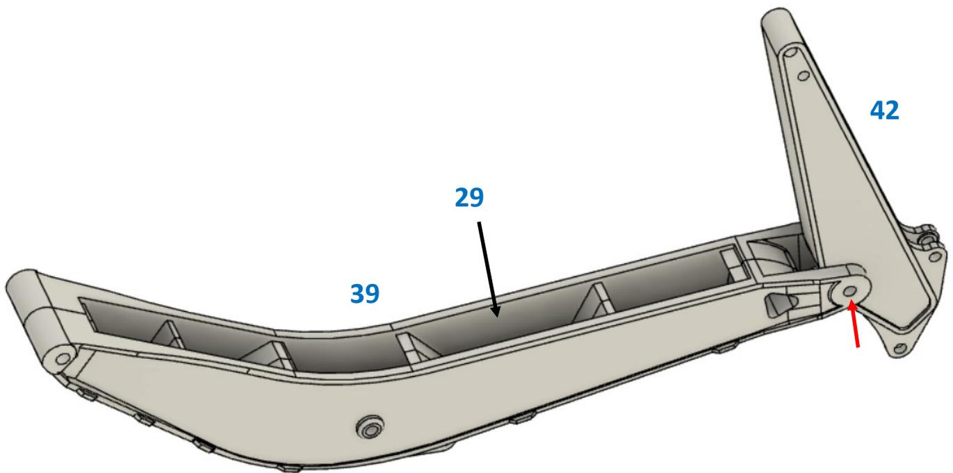
Frästeil 29 etwas biegen und mit Sekundenkleber an der Unterseite von Bauteil 39 verkleben. Die Bauteile 39 und 42 können nach dem Lackieren mit dem beiliegenden Rundprofil beim roten Pfeil verbunden werden.
