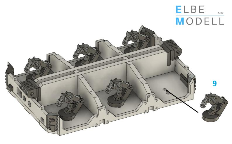
Die Radsätze können mit einem 7,5mm Stück des beiliegenden 1mm Rundprofils als Achse verbunden werden. Dafür kann es hilfreich sein, die Bohrung für die Aufnahme der Achse nachzubohren.
