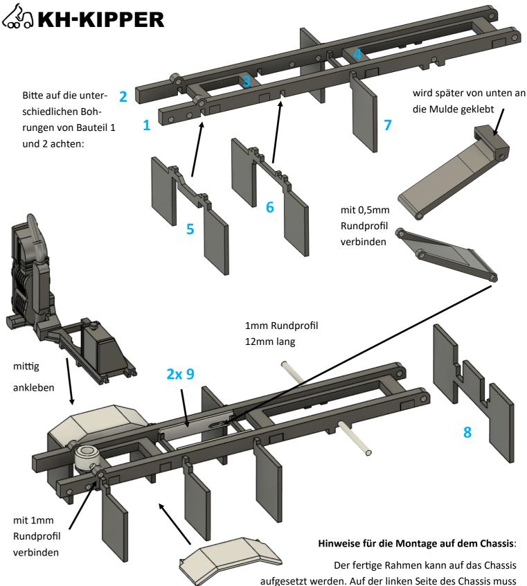
der Tank und die mittlere Aufnahme des Tanks entfernt werden, damit der neue Tank später angesetzt werden kann. Der Batteriekasten muss abgeschnitten und etwa 1mm dichter am Chassis wieder montiert werden, damit eine Seitenverkleidung davor Platz findet. Bauteil 8 kann nach dem Entfernen des Zugmauls von hinten an das Chassis geklebt werden. Ein Foto des vorbereiteten Chassis findet sich auf der letzten Seite.
