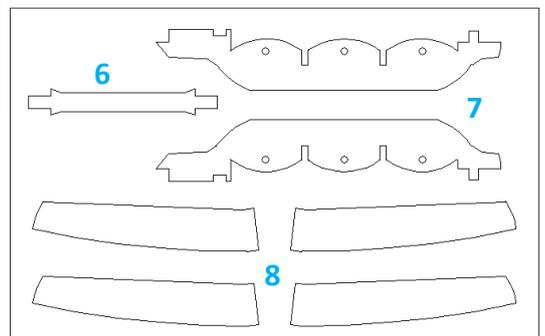
Zwischen Chassis und Bauteil 7 können, die dem Bausatz als Auffahrampen beiliegenden Bleche, montiert werden. Die Löcher in Bauteil 7 können bis zur anderen Seite mit einem 1,1mm Bohrer durchgebohrt werden, um die Achsen Durchstecken zu können.
