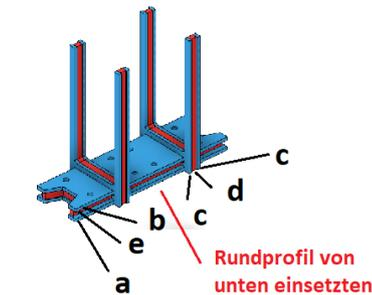
Die Riffelblecheinlagen je nach Lackierung an den Seiten leicht schleifen oder vor dem lackieren einsetzen
