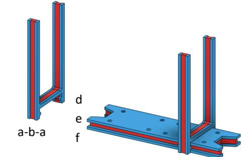
Die Rungen können mit dem beiliegenden Rundprofil auf die Chassis Montiert werden
