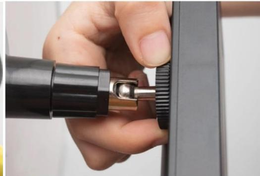
**5 - Visser le capuchon de la lampe dans le sens des aiguilles d'une montre et serrer les écrous en plastique**
