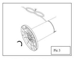
• Tighten the lock nut。 (pic3)
