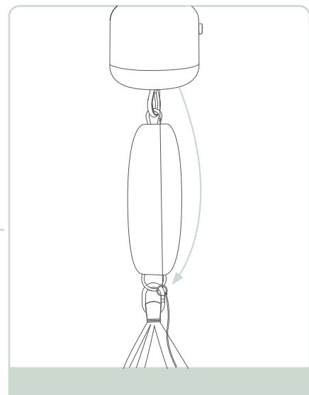
**5** Montering af motorens wire
