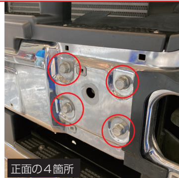
ナンバーサイドのガーニッシュ RL とも外す。引っ張れば外せます。
