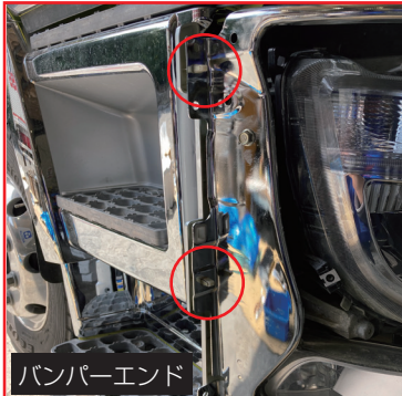
ナンバーサイドのガーニッシュ RL とも外す。引っ張れば外せます。
