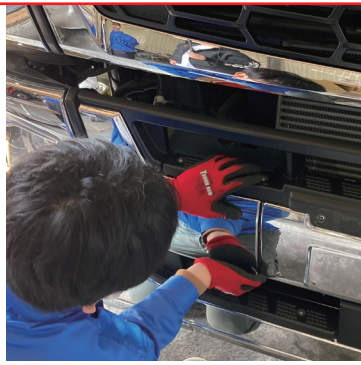
ナンバーサイドのガーニッシュ RL とも外す。引っ張れば外せます。
