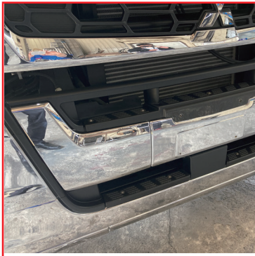
ナンバーサイドのガーニッシュ RL とも外す。引っ張れば外せます。
