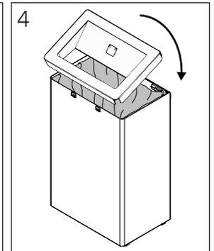
Einwurfdeckel aufsetzen. Auf korrekte Ausrichtung und richtigen Sitz hinten und vorne achten.
