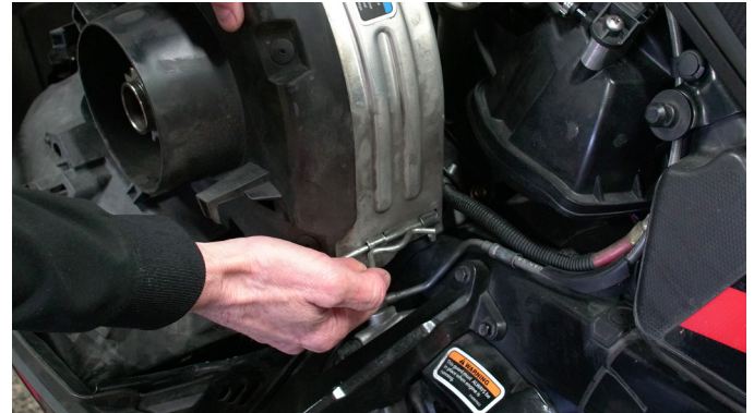
RETIRER LE PROTECTEUR SUPÉRIEUR DE L'EMBRAYAGE.
