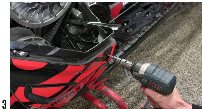
DÉVISSER LA VIS SUR LE CÔTÉ DE LA CARROSSERIE
