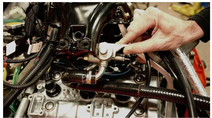
Étape 2 - Débranchez et retirez le tuyau qui relie la valve (PCV positive crankcase ventilation) à la boîte à air d'origine
