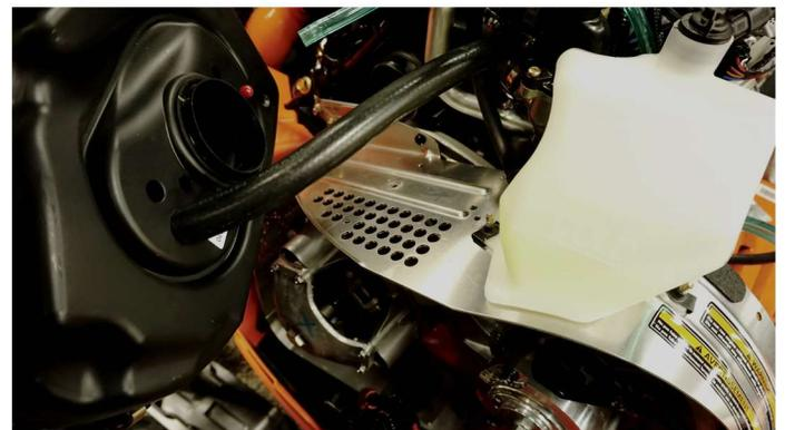
Étape 3 - Branchez la partie en forme de "U" du tuyau d'évent Précision EFI à la valve (PCV) en utilisant l'anneau de serrage d'origine. Ensuite dirigez le tuyau vers le bas, côté droit en suivant les câbles et le tuyau qui mènent au réservoir d'huile moteur
