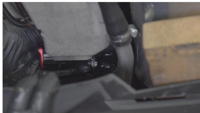
*VISSER LE COLLET À 3 MM DU BOUT DU TUYAU ET VÉRIFIER LE BON VISSAGE DE L'ENSEMBLE*
