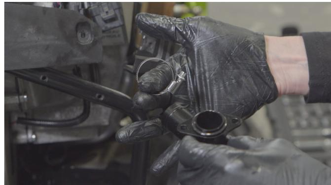
**8** *INSTALLER LE COLLET SUR LE TUYAU DE CAOUTCHOUC AVANT D'INSÉRER LA NOUVELLE PIÈCE*
