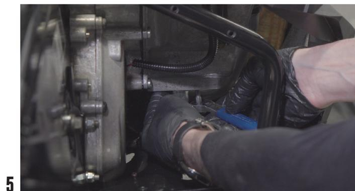
**5** DÉVISSER LES 2 VIS DU COUDE MÉTALLIQUE SITUÉ EN DESSOUS DU RÉSERVOIR (PRÉVOYEZ LA VIDANGE D'UN MINIMUM DE 3 LITRES D'HUILE) ET ABSORBER L'EXCÈS D'HUILE RÉPANDU SUR LE PLANCHER DU COMPARTIMENT MOTEUR
