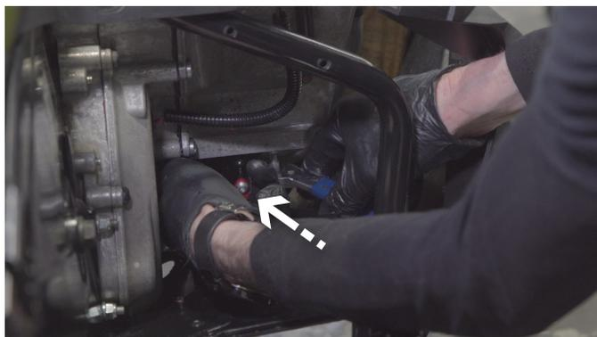
**9** *INSTALLER ET VISSER LE EASY OIL CHANGE SOUS LE RÉSERVOIR EN UTILISANT LES VIS D'ORIGINE*
