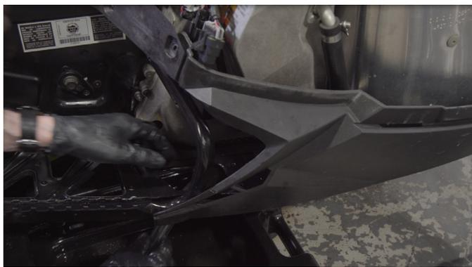
**4** PLACER UN BAC DE VIDANGE D'HUILE SOUS LE MARCHEPIED, NOUS SUGGÉRONS FORTEMENT DE SOULEVER LE DEVANT DE LA MOTONEIGE D'AU MOINS 40 CENTIMÈTRES, À L'AIDE D'ESPACEURS SOUS LES SKIS OU AVEC UN CHAIN BLOCK, POUR ÉVITER QUE L'HUILE SE RÉPANDE SOUS LE SILENCIEUX
