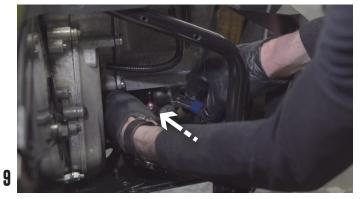
INSTALL THE EASY OIL CHANGE USING THE OEM SCREWS
