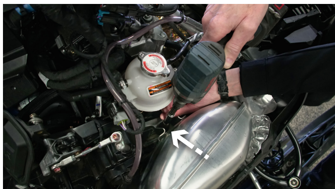
1 INDIQUER LE CÔTÉ DES RESSORTS POUR UNE INSTALLATION PLUS FACILE ENSUITE RETIRER LES RESSORTS DU JOINT QUI CONNECTE LE DOWNPIPE AU SILENCIEUX.
