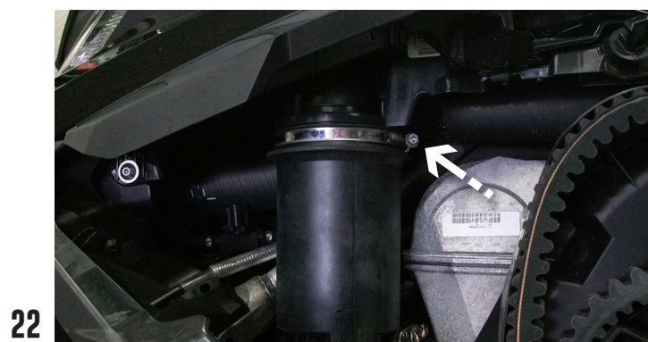
22 À L'AIDE D'UNE PERCEUSE ET UN EMPORTE PIÈCE 2 POUCHES, COUPER LA GRILLE DE L'ENTRÉE DU SILENCIEUX. SI LA GRILLE TOMBE DANS LE SILENCIEUX, RETIREZ-LA AVEC UN OUTIL DE REPÊCHAGE MAGNÉTIQUE.
