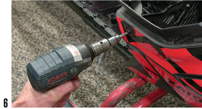
4 ENLEVER LE CAPOT ET L'ENTRÉE D'AIR. NE PAS OUBLIER DE DÉCONNECTER LES LUMIÈRES AVANT ET LES LUMIÈRES OPTIONNELLES SI PRÉSENTES.
