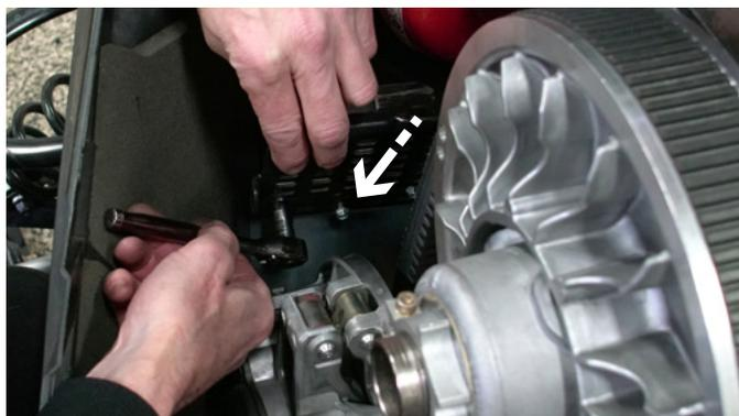
**9** *VISSER LE SUPPORT DU PROTECTEUR SUPÉRIEUR D'EMBRAYAGE À LA BELLY PAN, VEUILLEZ ATTENDRE AVANT DE LE VISSER AU CHÂSSIS.*
