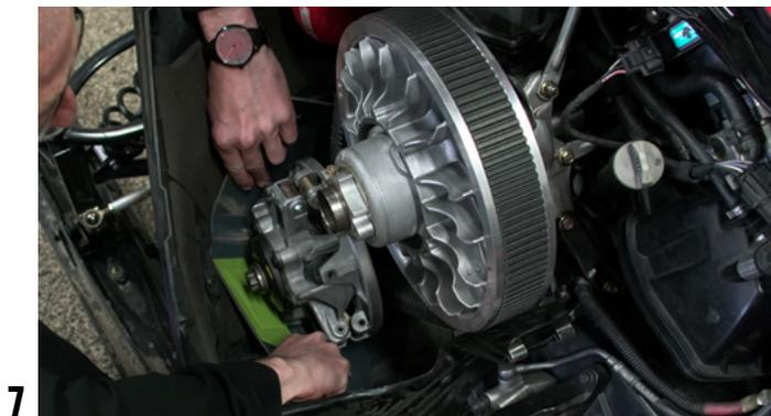
**7** *INSÉRER LA BELLY PAN SOUS L'EMBRAYAGE EN DOUCEUR EN ÉCARTANT LA PAROI DE LA CARROSSERIE VERS L'EXTÉRIEUR POUR PERMETTRE PLUS D'ESPACE.*
