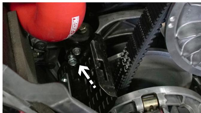
**11** *ENSUITE, VISSER LE SUPPORT DU PROTECTEUR SUPÉRIEUR AU CHÂSSIS ET TERMINER EN VISANT L'ENSEMBLE DES BOULONS DE LA BELLY PAN.*
