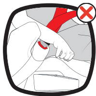
POSICIÓN INCORRECTA DE LA HEBILLA DEL CINTURÓN
