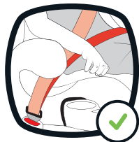
POSICIÓN CORRECTA DE LA HEBILLA DEL CINTURÓN
