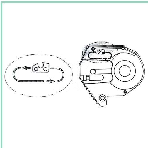
2. Setzen Sie das Kettenblatt auf die Säge.
