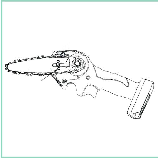
Ziehen oder lösen Sie bei Bedarf die Kette mit dem mitgelieferten Schraubendreher.
