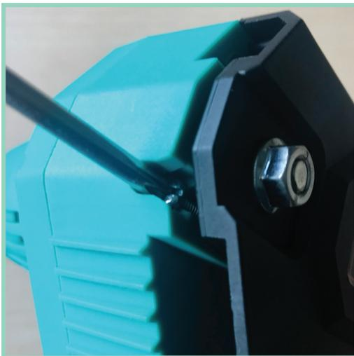
3. Abdeckung (3) und Sechskantmutter(4) montieren und mit dem mitgelieferten Schraubenschlüssel (5) festziehen.
