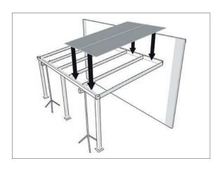
**57. Polykarbonatplatten auflegen**Lege zwei Polykarbonatplatten mit dem
