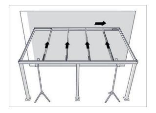
**47. Kabel führen (Optional)** Führe die Kabel zu einem Stromanschluss.
