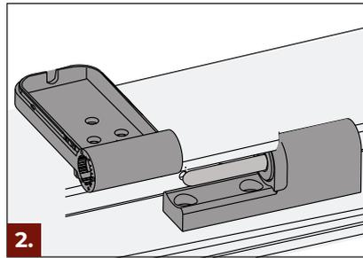
Das Band-Flügelteil an den Bandstift einstecken durch leichte Drehbewegungen einfügen. Dabei darauf achten, dass die Verzahnung korrekt eingreift.
