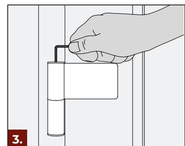
Andruckverstellung: Abdeckkappe entfernen, verstellen des Dichtungsandrucks um bis zu +/- 6 mm.
