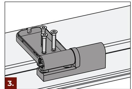
Band-Flügelteil mit beiliegenden 3 Schrauben befestigen (Positionen durch Bohrungen festgelegt).
