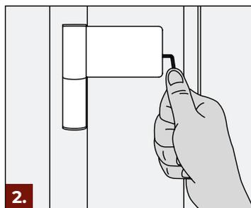
Seitenverstellung (bis zu +/- 6 mm): Seitlichen Abdeckstopfen entfernen (kein Lösen von Klemmschrauben!).
