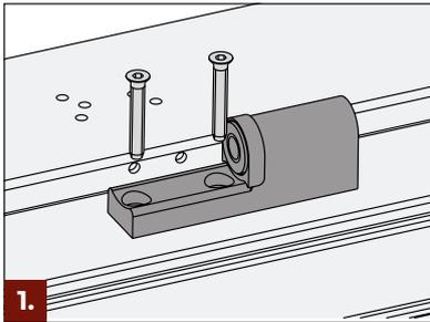
Band-Rahmenteil aufsetzen, dabei die Bolzen in die Bohrungen einführen, anschließend mit beiliegenden Schrauben befestigen.
