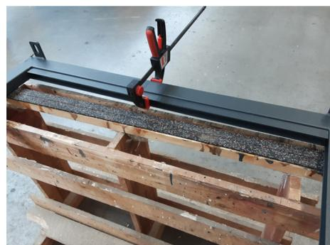
3. Setze die schwarzen Endkappen beidseitig auf die Lamellen und fülle die Tür von oben nach unten mit den Lamellen.
