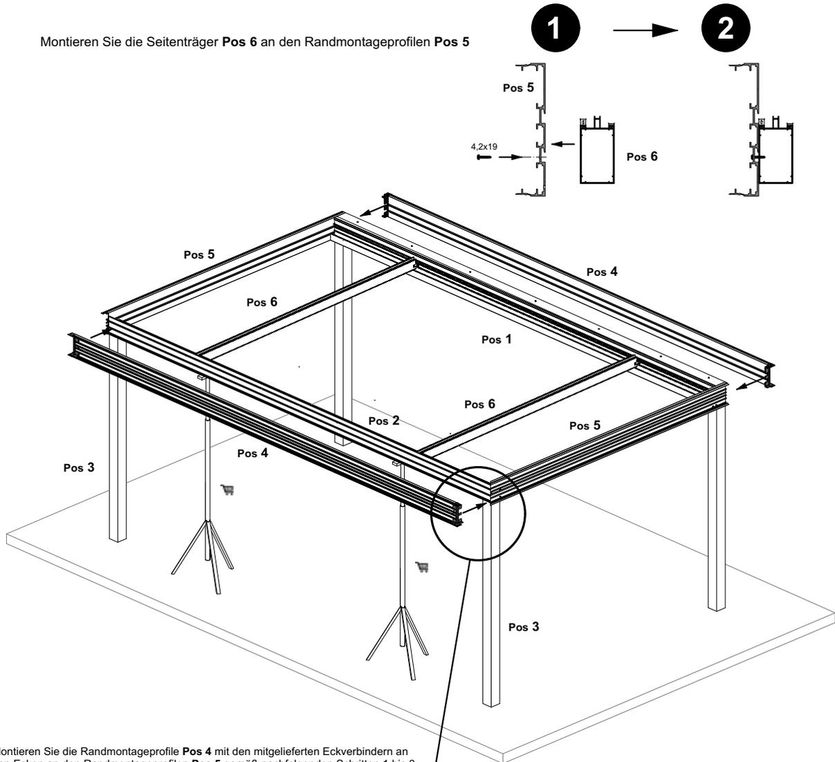
Montieren Sie die Randmontageprofile **Pos 4** mit den mitgelieferten Eckverbinder an den Ecken an den Randmontageprofilen **Pos 5** gemäß nachfolgenden Schritten 1 bis 3
