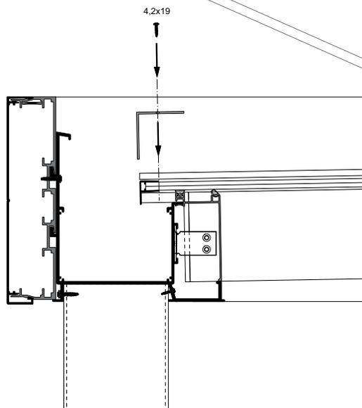
Montieren Sie die Plattenstopper auf den Abdeckern **Pos 8** und schrauben Sie diese mit den mitgelieferten Farbkopfschrauben fest
