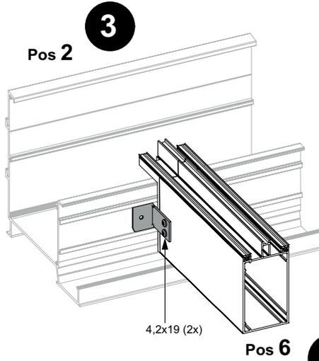
Befestigen Sie den Edelstahl-Montagebügel mit 2 Schrauben am Träger
