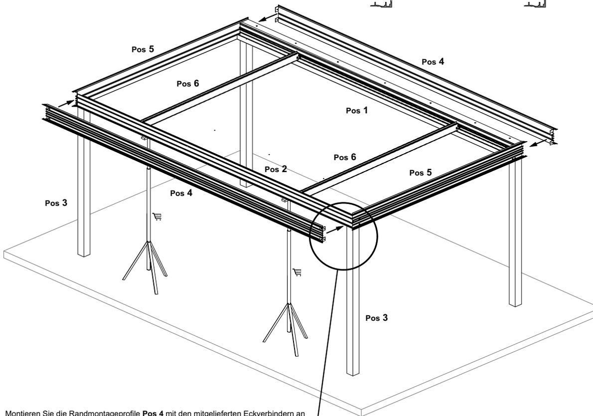
Montieren Sie die Randmontageprofile **Pos 4** mit den mitgelieferten Eckverbinder an den Ecken an den Randmontageprofilen **Pos 5** gemäß nachfolgenden Schritten 1 bis 3
