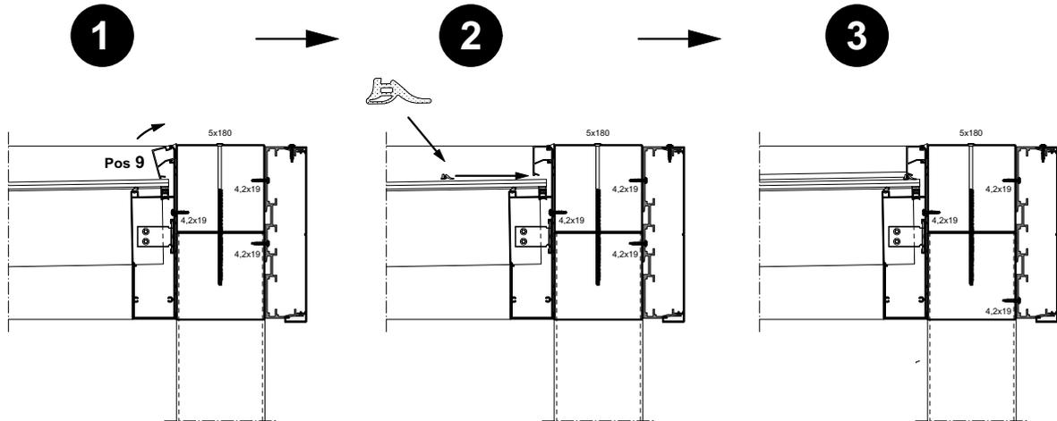
Drehen Sie die Glasleiste **Pos 9** gemäß oben stehender Detailzeichnung in das Mauerprofil bis dieses festklickt
