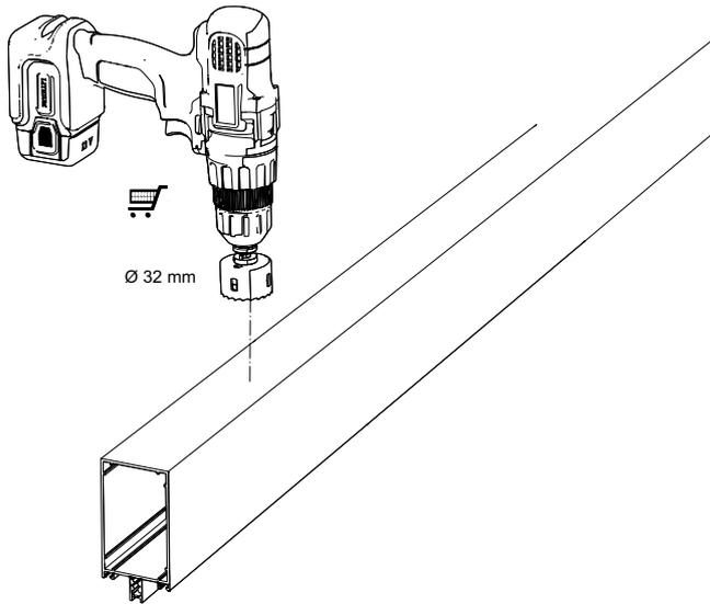
Bestimmen Sie die Position der Spots und bohren Sie Löcher in die Träger (maximal 3Stück pro Träger)
