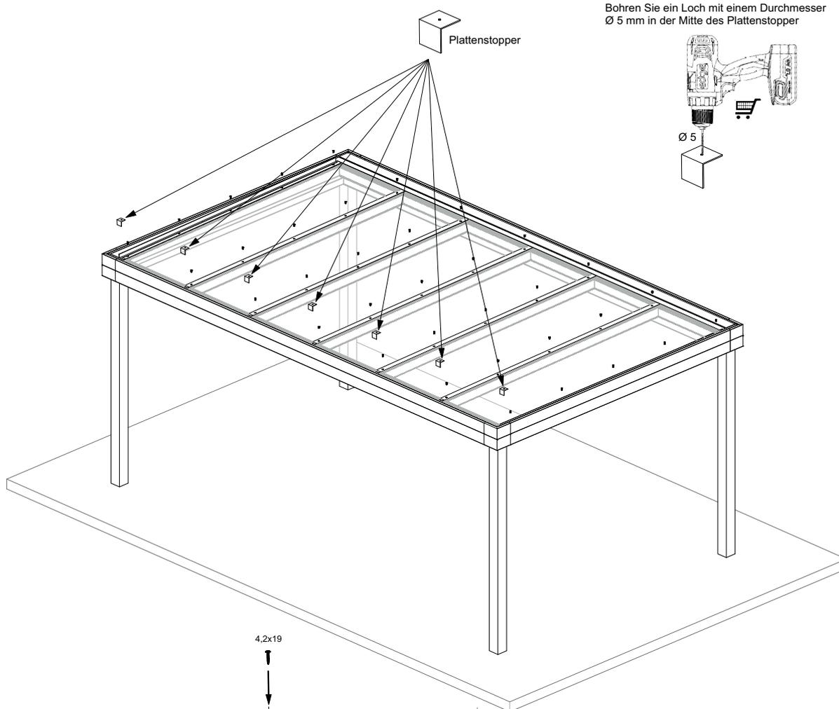
Bohren Sie ein Loch mit einem Durchmesser  $\varnothing 5$  mm in der Mitte des Plattenstopper
