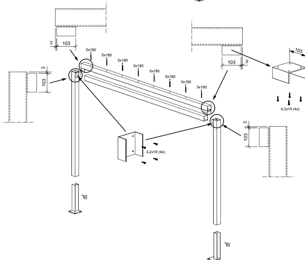
Eine freistehende Konstruktion sollte, um die benötigte Stabilität zu gewährleisten, immer auf Stahlankerfüßen montiert werden
