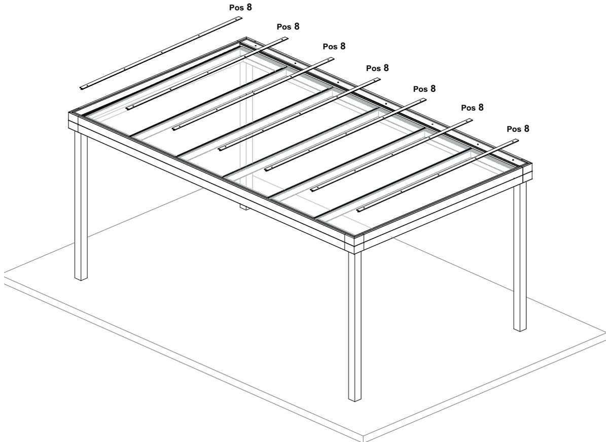
Montieren Sie die Abdecker **Pos 8** und schrauben Sie diese mit den mitgelieferten Farbkopfschrauben fest
