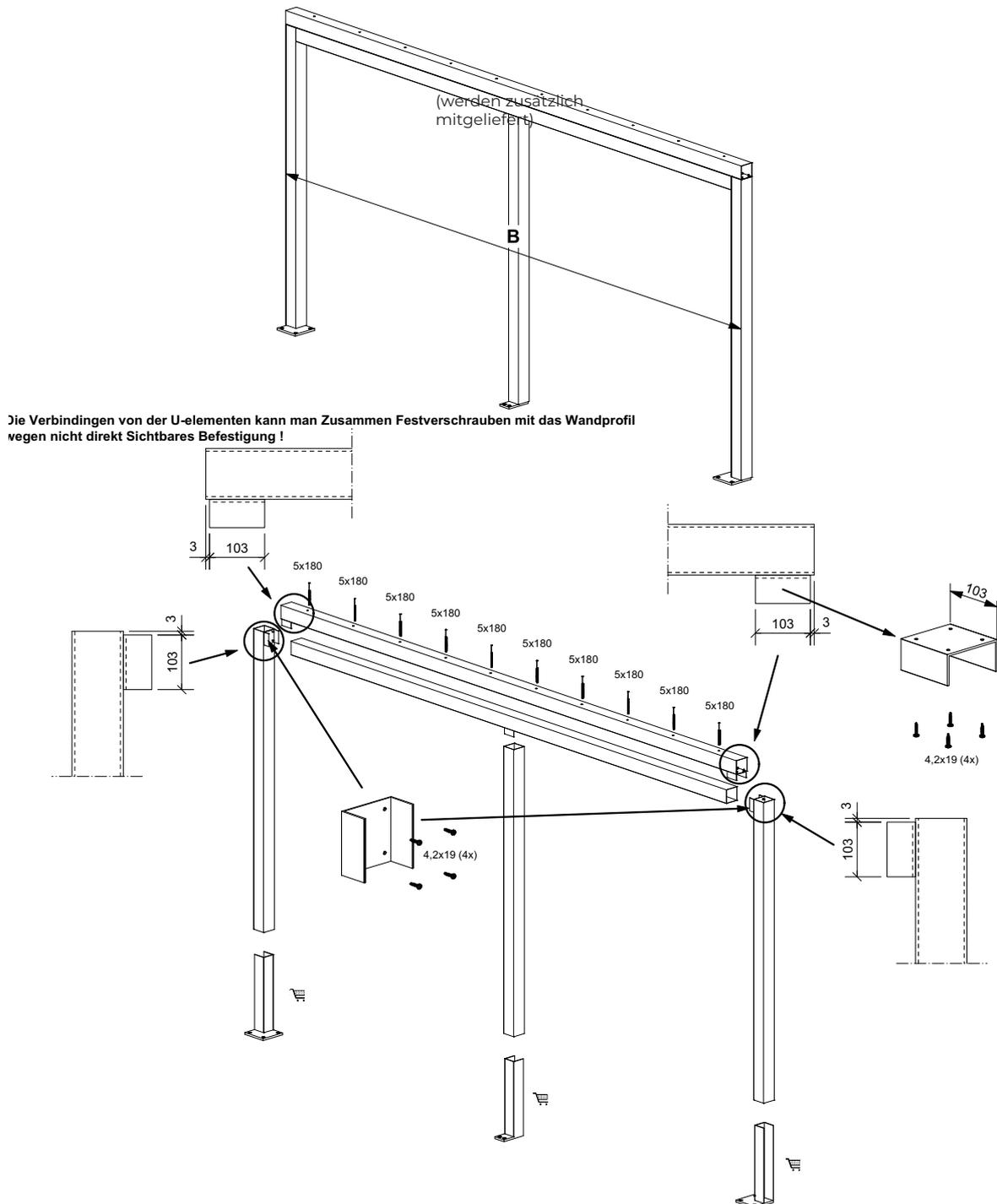
**Eine freistehende Konstruktion sollte, um die benötigte Stabilität zu gewährleisten, immer auf Stahlankerfüßen montiert werden**
