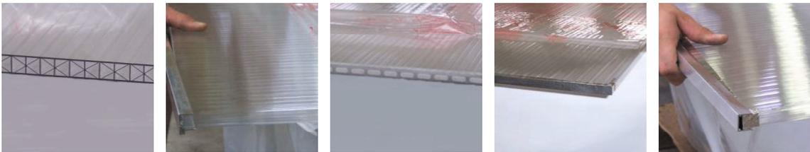
Die untere Stirnseite wird mit dem Aluminium-Tropfkantenprofil verschlossen. Die Stirnseiten müssen vorher noch zusätzlich mit einem atmungsaktiven „Anti-Dust“-Klebeband abgeklebt werden. Vorab wird die Schutzfolie an den Querseiten ein Stück abgelöst.
