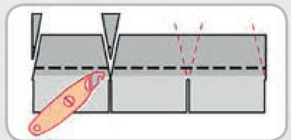
4. Verlegen Sie die Firstschindelstücke nach der Prinzip der Doppeldeckung. Bei kalter Witterung empfehlen wir die Schindeln für ein erleichtertes Biegen zu erwärmen.
