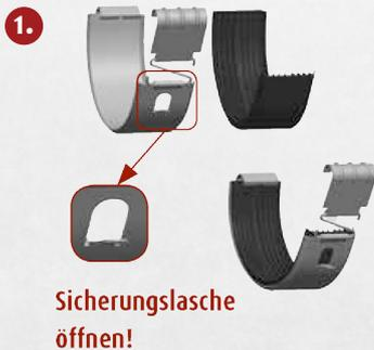
Öffnen Sie die Sicherungslasche und kleben Sie die Gummidichtung bündig zur Ausklinkung ein (vorne auf der Wulstseite überstehen lassen)
