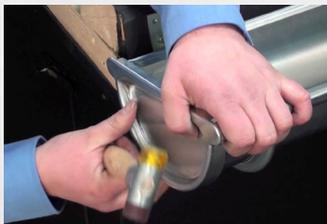
Der Steckbodenboden wird auf das rechte oder linke Ende der Dachrinne aufgesteckt und mit einem Gummihammer o.ä. auf die Dachrinne aufgeschlagen. Die Gummlippe verschließt so dicht das Rinnenende und das Löten entfällt. Die u-förmige Vertiefung gibt dem Rinnenboden mehr Stabilität und besten Halt an der Dachrinne.
