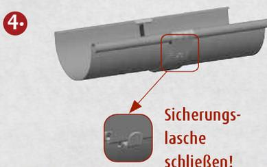
Legen Sie die Wulstklammer über die Wulst und lassen Sie diese nach unten einschnappen. Schließen Sie die Sicherungslasche. Wenn der Schnappeffekt fehlt, überprüfen und korrigieren Sie ggfs. die Rinnenform.
