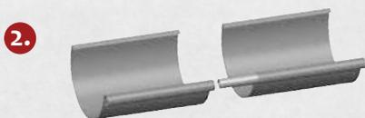
Verbinden Sie die beiden Rinnen durch Einstecken des Wulstverbinders stabil miteinander. Überprüfen Sie beide Rinnen auf die richtige Form hin und biegen Sie diese ggfs. in Form. Zur Dilatation der Rinnen montieren Sie diese mit 5 mm Abstand.
