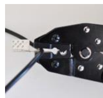
Figur 4.6 A Presstang eksempel av Norelko tilkoblingsklemmer
