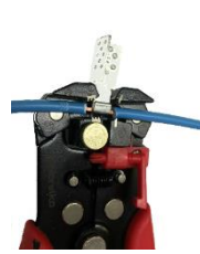
Figur 4.5 A Avisolering av RKK med Norelko klemme
