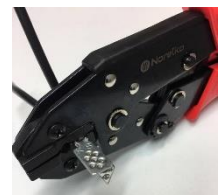
Figur 4.6 B Presstang eksempel av standard tilkoblingsklemmer
