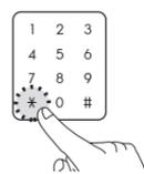
**NOTA** La contraseña debe ingresarse mientras la luz del panel numérico está encendida, y si el panel está apagado, toque el teclado nuevamente e ingrese la contraseña una vez más. Cuando se ingresa una contraseña incorrecta 5 veces seguidas, el bloqueo de la puerta se suspenderá durante 1 minuto con un sonido de advertencia. Cuando se borre la suspensión, la cerradura de la puerta funcionará normalmente y se debe ingresar una contraseña correcta para abrir la puerta.
