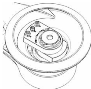
2. Maskinkonfigurasjon for bruk med Pad saver eller mellomskive.
