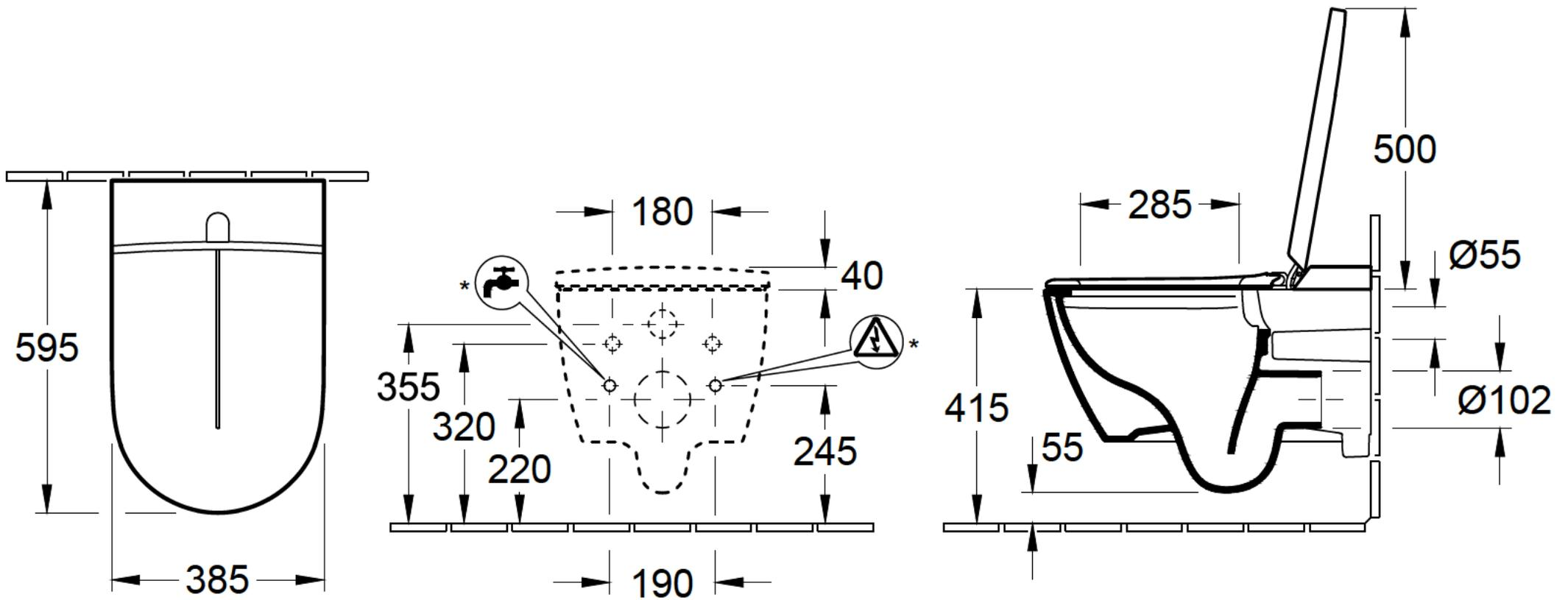
\* Wasser- und Stromanschlussposition in Verbindung mit ViConnect (Art. Nr. 9224 61 00)
