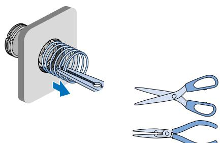
Auch die vierte Komponente lässt sich mittels spitzer Zange oder Schere aus der Fassung entfernen.
