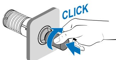
Controleer of de jet correct is geplaatst door lichtjes aan de zuignap te trekken.
