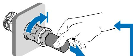
Duw de Invisible Jet stevig terug en draai hem tegelijkertijd tegen de wijzers van de klok in, totdat u een klik hoort.
