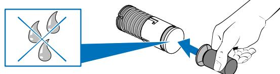
Poussez la buse dans son logement en la tournant simultanément dans le sens des aiguilles d'une montre et en sens inverse.
