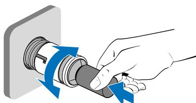
Wenn die Düse vollständig in die Fassung eingeführt ist, den Saugnapf kräftig drücken und im Uhrzeigersinn drehen, bis ein deutliches Klicken zu hören ist.
