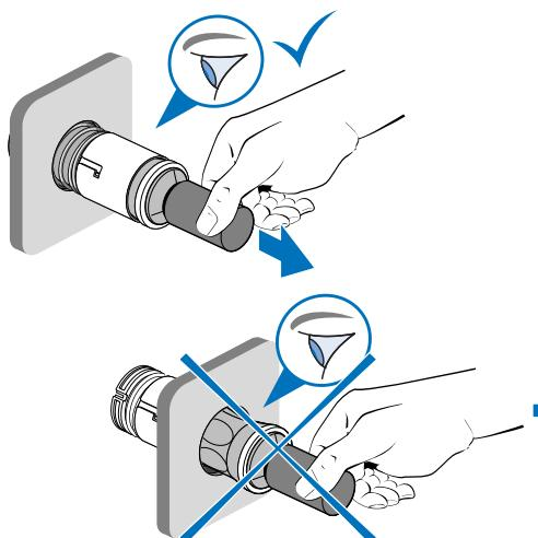
Draai de jet, om hem er helemaal uit te kunnen halen, met de klok mee of tegen de klok in en trek tegelijkertijd totdat de jet uit de houder loskomt.
