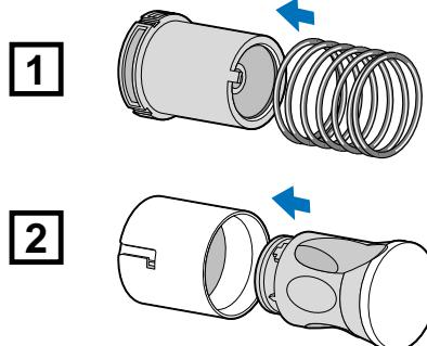
Les deux tenons **ne** doivent **pas** se retrouver face à face lors de l'assemblage des deux moitiés de buse.
