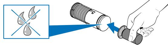
Düse in die Fassung schieben und gleichzeitig im Uhrzeigersinn und gegen den Uhrzeigersinn drehen.
