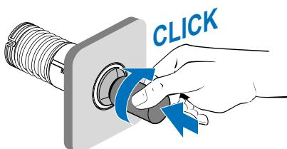
Überprüfen Sie den korrekten Sitz der Düse, indem Sie den Saugnapf leicht ziehen.
