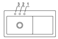
Lochbohrungen: Bei der Bestellung bitte Nummer(n) angeben. Durchmesser: ca. 35 mm
