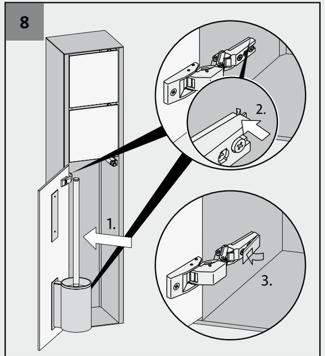
einstellungen scharniere · adjusting hinges · réglage des charnières · instellen van de scharnieren
