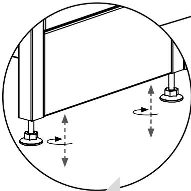
**Hinweis:** Passe die Höhe der Bar an die Höhe der Module an, indem du die Füße einfach rein- und/oder rausschraubst.
