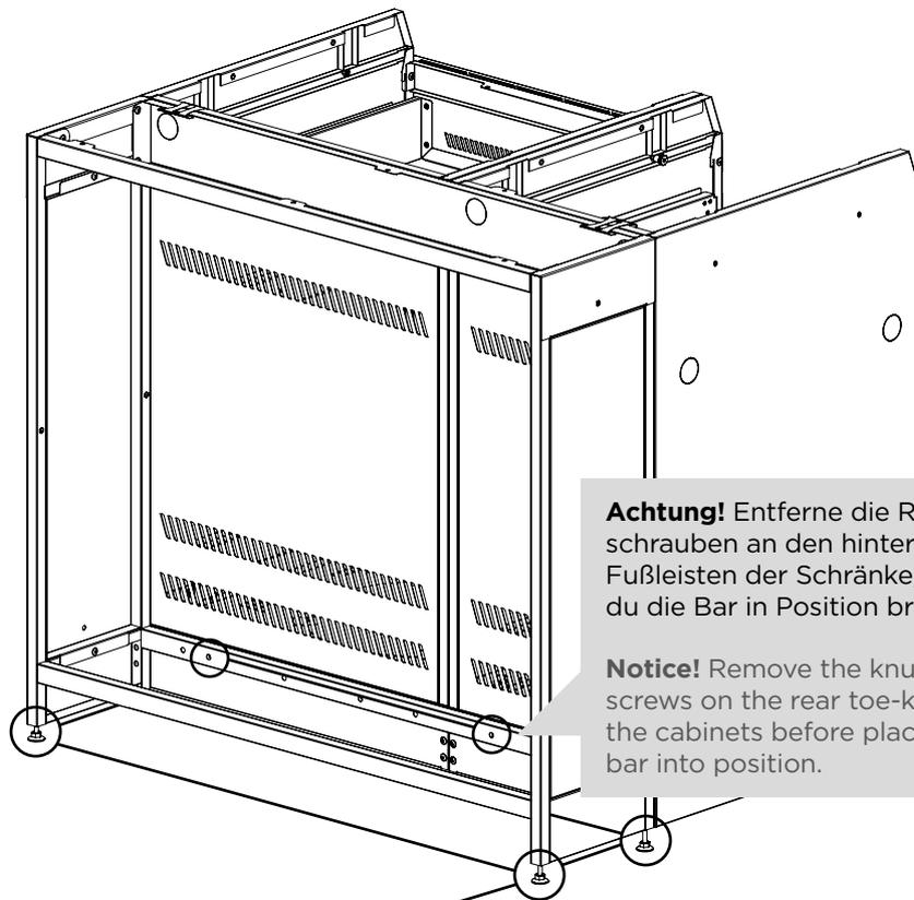
**Achtung!** Entferne die Rändelschrauben an den hinteren Fußleisten der Schränke, bevor du die Bar in Position bringst.
