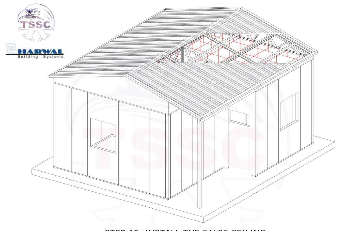
STEP 12: INSTALL THE FALSE CEILING STEP 13: FIX THE DOORS & WINDOWS
