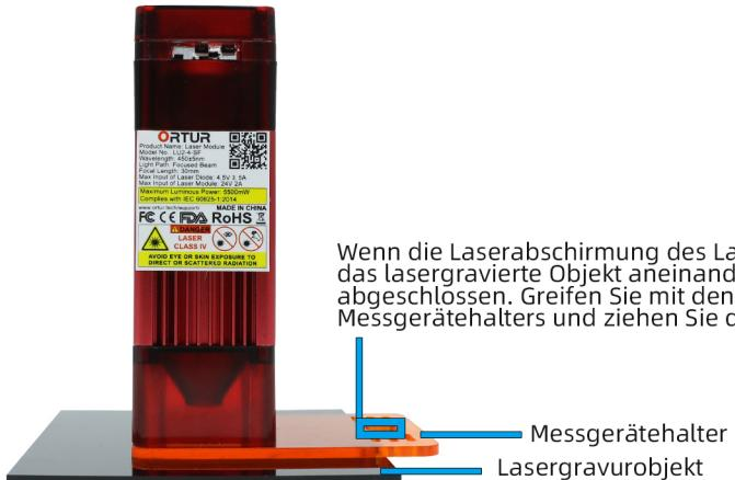
Wenn die Laserabschirmung des Lasermoduls, der Messgerätehalter und das lasergravierte Objekt aneinander befestigt sind, ist die Fokussierung abgeschlossen. Greifen Sie mit den Fingern in das Loch des Messgerätehalters und ziehen Sie den Messgerätehalter heraus.
